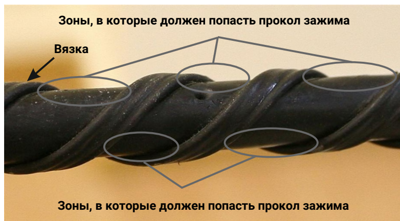
Рисунок 4 - Верное место расположения прокола зажима на проводе
