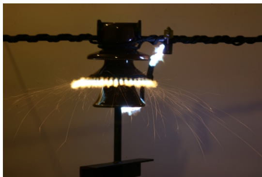
Рисунок 6 - Фотография изолятора-разрядника ИРШФМК-10(20)-III(I)-УХЛ1 при срабатывании
